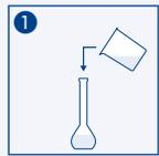
1 20 mL Probe in einen 25 mL Messkolben füllen
