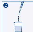
2 Ein Becherglas (alternativ Leerküvette) mit 10 mL Probe befüllen
