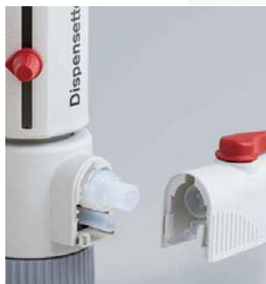
Ventilsystem ohne Dichtringe
