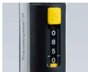
Volumenverstellschutz gegen versehentliches Verstellen
